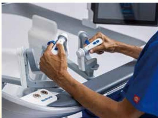
図2. 術者の手の動きをロボットアームが再現します。ロボットアーム先端の鉗子には多くの関節があり人の手よりも自由自在に動きます。
